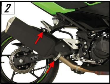
Montieren Sie den REMUS-Sportschalldämpfer mittles des beigelegten Halters (!!ACHTUNG!! (Abb.5)) und ziehen Sie die beiden Schrauben des Halters und die der Schelle fest. Mount the Remus REMUS muffler within the included bracket (!!ATTENTION!! (pic.5)) and tighten the screws of the bracket and the clamp.
